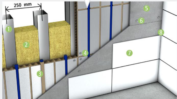
Für die Wandmontage werden die Trockenbauplatten quer zu den Trockenbauprofilen angeordnet
